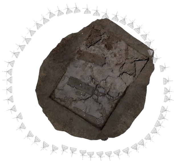
Fig. 12 - Nora, Area della Marina Militare, Settore I, saggio 1. Visualizzazione dall'alto delle camere relative ad un dataset di immagini utilizzato per il rilievo 3D tramite dense stereo matching (campagna di scavo 2014).
