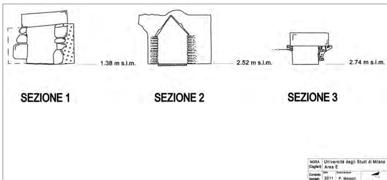
**Figura 9b** – Il percorso del condotto fognario e le diverse tecniche costruttive utilizzate, visibili dalle sezioni (campagna 2011).
